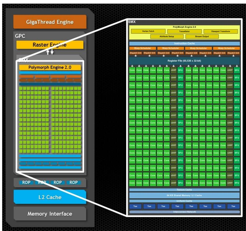
圖 8：Tegra K1 的完整 Kepler GPU (左) 和 Kepler SMX 單元 (右)
